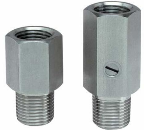
Сконструированы для защиты приборов измеряющих давления в приложениях связанных с пульсирующим давлением. Внезапные изменения давления демпфируются до того, как они достигнут чувствительного элемента, защищая его от высокой нагрузки. Это облегчает считывание замера давления и помогает продлить ресурс работы прибора.
